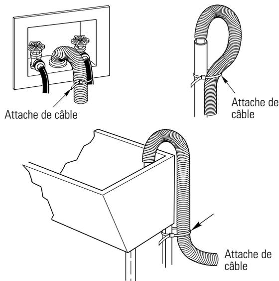
7. Recourber l'extrémité du tuyau de vidange pour former un U. Accrocher le tuyau sur le bord d'un bac de buanderie ou dans la canalisation d'évacuation verticale, et immobiliser le tuyau avec l'attache de câble fournie.
