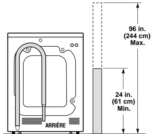
**REMARQUE :** Le tuyau de vidange flexible connecté à la laveuse est assez long pour qu'on puisse l'introduire dans une canalisation verticale dont l'orifice est à 58 po (147 cm) du sol. Si la canalisation verticale est plus haute, contacter un distributeur de pièces agréé. Si la hauteur de la canalisation verticale est inférieure à 24 po (61 cm), installer un dispositif brise-siphon (disponible dans toute quincaillerie locale).
