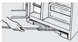
Limpie las bobinas del condensador al menos una vez al año.
